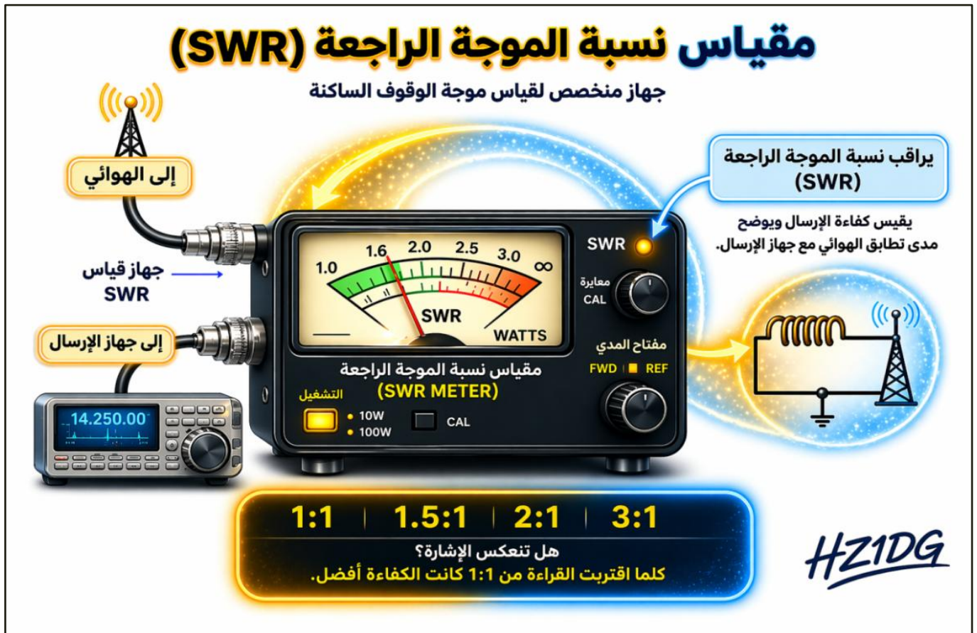
شكل (15-6): مقياس نسبة الموجة الراجعة (SWR Meter) ومراقبة كفاءة الإرسال
