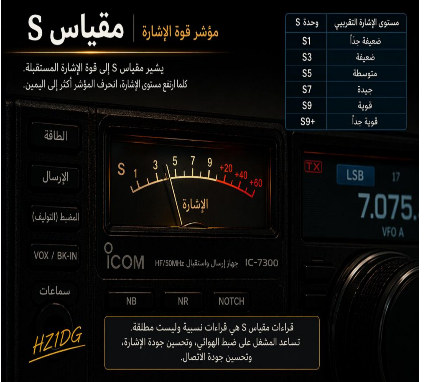
شكل (8-7): مقياس الإشارة S-Meter
