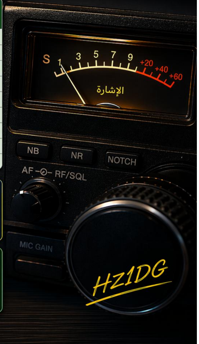
شكل (9-7): مقياس الإشارة بعد (S-Meter +dB) S9
