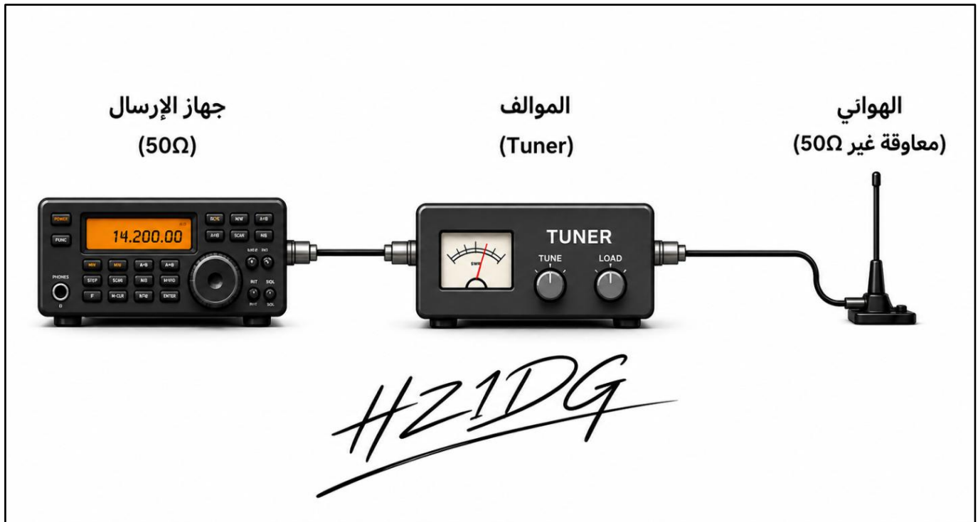
شكل (2-8): استخدام الموالف لمطابقة المعاوقة بين جهاز الإرسال (50 أوم) وهوائي غير متوافق.
