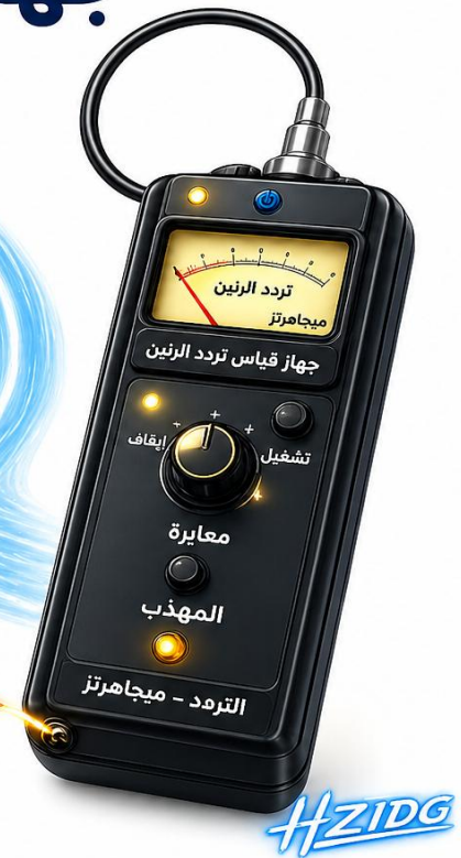
شكل (6-13): جهاز Dip Meter لقياس تردد الرنين
