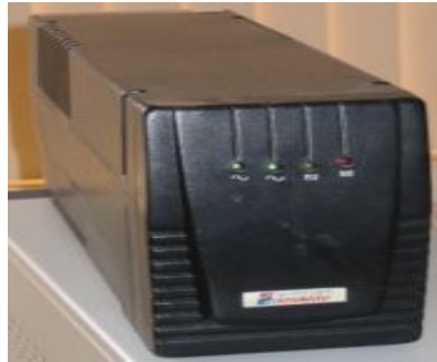
شكل ( 7- 27 ) مجهز القدرة للحاسبات غير القابل للقطع
