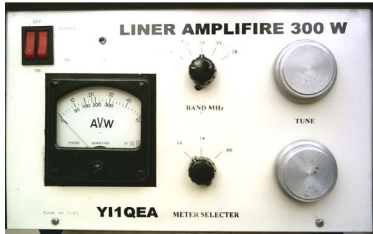
شكل ( 2 - 31 ) جهاز مكبر للقدرة الراديوية ( من صنع المؤلف )
