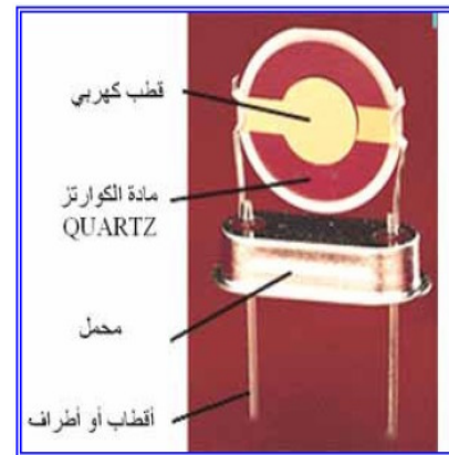
شكل ( 2 - 34 ) صورة تفصيلية لداخل لبلورة الكوارتز وصور لأنواع منها
